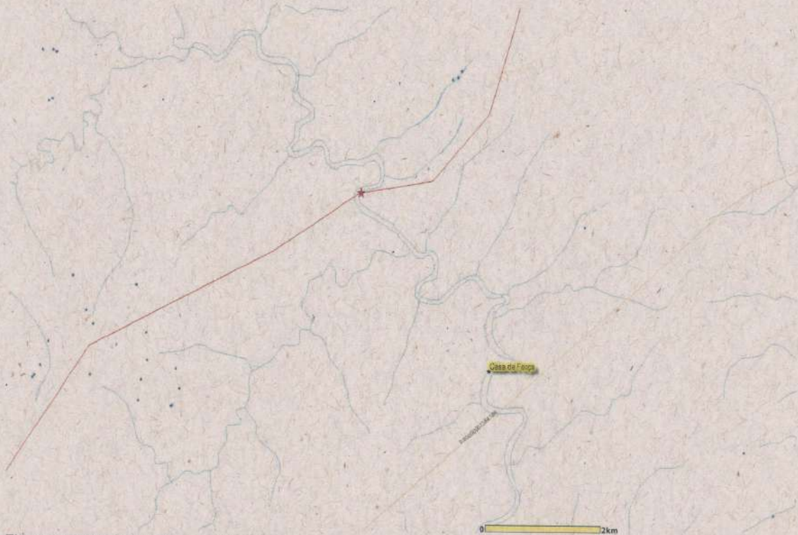
Figura 3: Trecho de vazão reduzida entre a barragem e a casa de força, segundo o SIAM/Outubro-2016.
