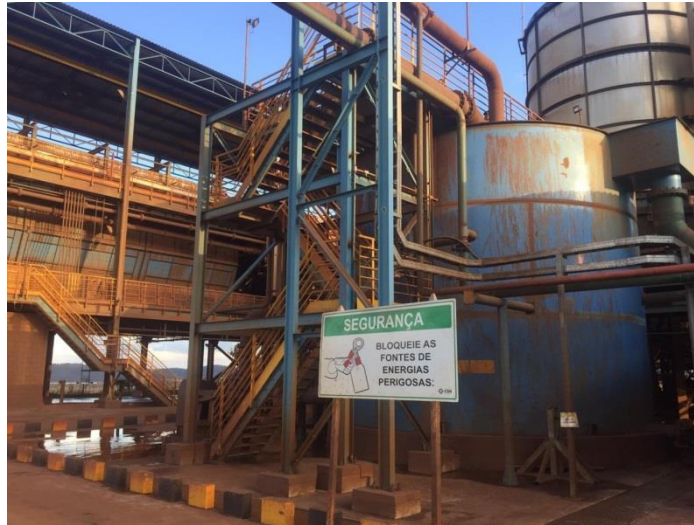
Foto 3: Processo de filtração de rejeito em operação. O material gerado da filtração será direcionado para a área de empilhamento sobre os drenos de fundo do Fraile.
