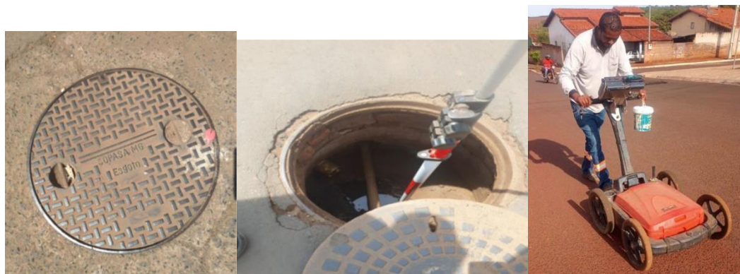
Registro dos serviços realizados com o GRP (GeoRadar) no município de Perdizes – MG.
