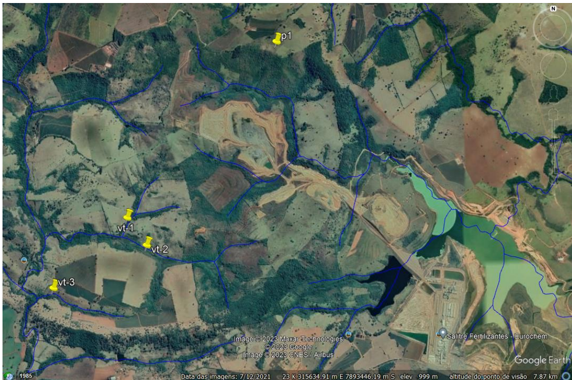
Figura 19. Sugestão para os poços de monitoramento do nível d'água e vazão nos cursos d'água.
