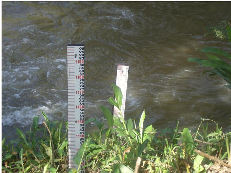
Figura 4: réguas fluviométricas já existentes
