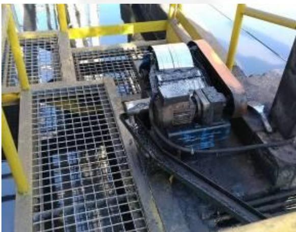
Foto 17. Retirada óleo tratamento efluentes gerados na laminação
