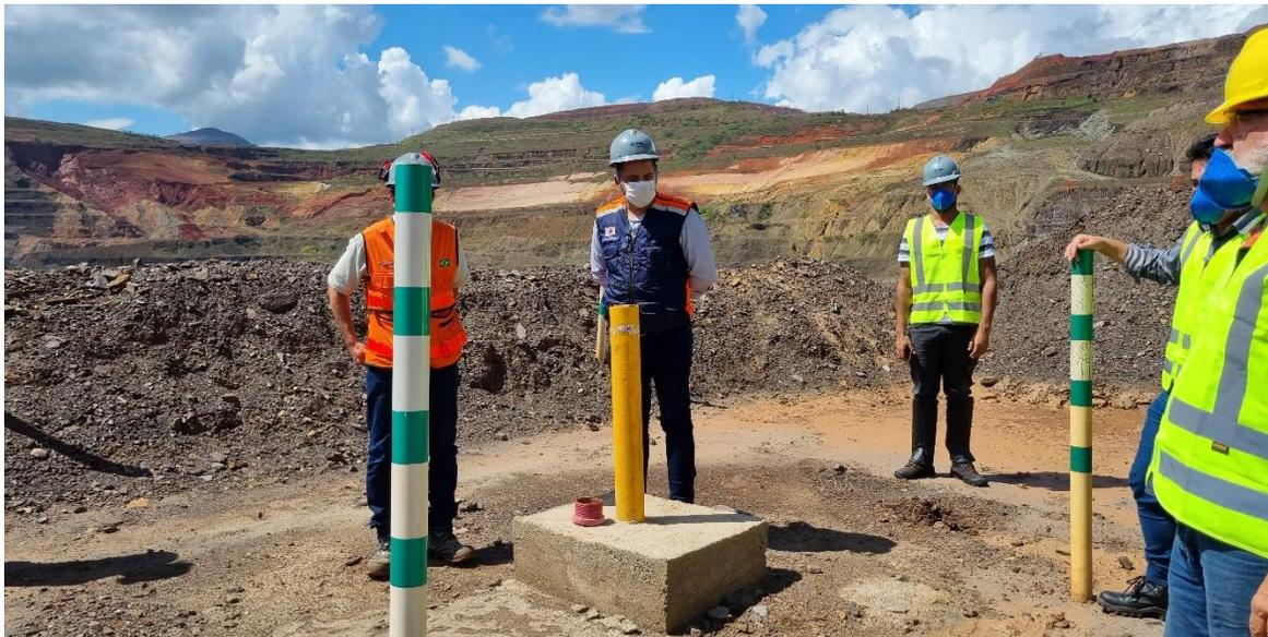
*Figura 10: Evidência de piezômetro instalado.*
