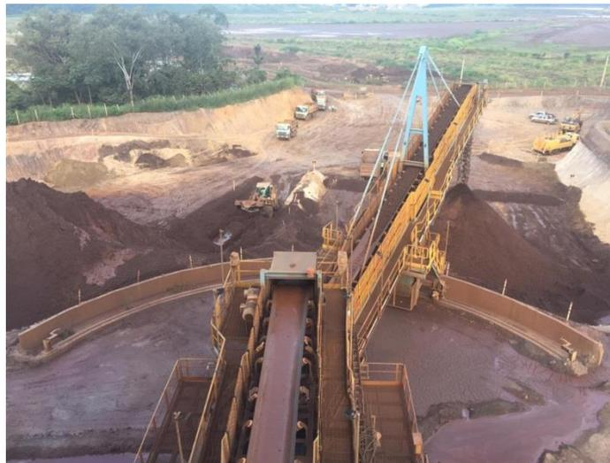
*Foto 4: Processo de filtração de rejeito em operação. O material gerado da filtração será direcionado para a área de empilhamento sobre os drenos de fundo do Fraile.*
