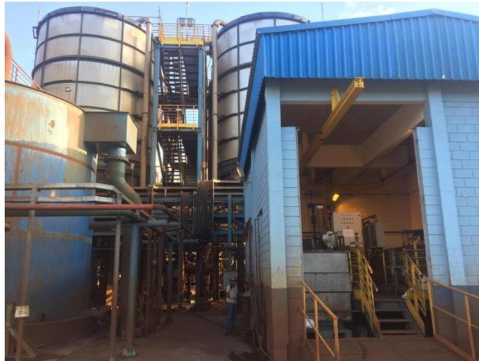
*Foto 2: Processo de filtração de rejeito em operação. O material gerado da filtração será direcionado para a área de empilhamento sobre os drenos de fundo do Fraile.*
